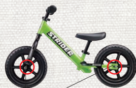
ナットの点検
